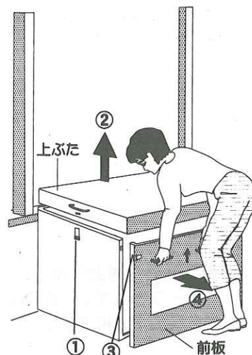
（ケンドン式） 止め金具を外し、上ぶたを取り前板を取り外す。
