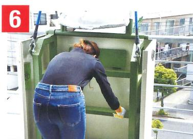
取付具のステップを手前に倒しセットします。
